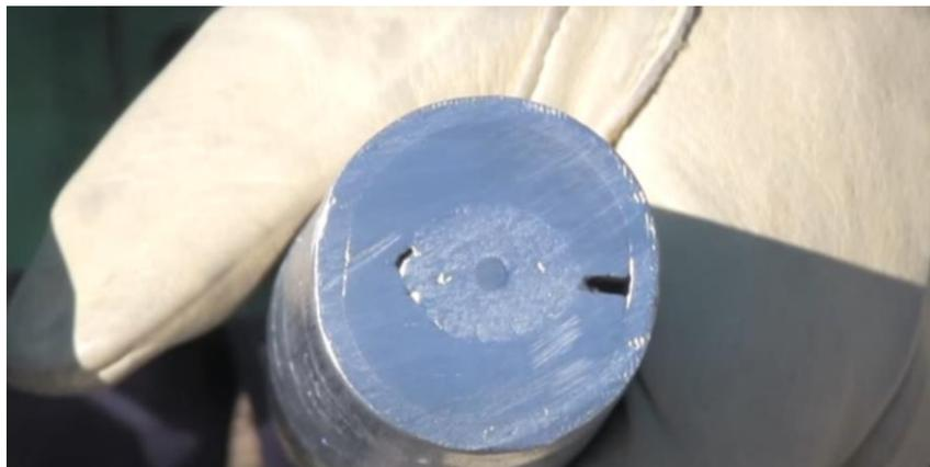
Aquí observamos como los dientes de las mordazas se incrustan en los hilos del conductor después de aplicar la tensión
