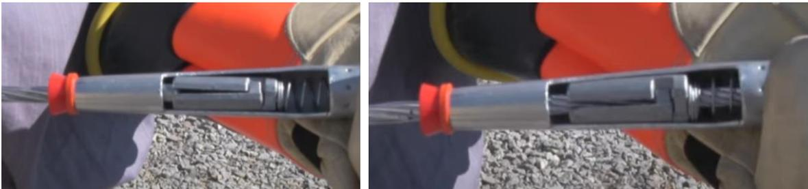
*El cono de bloqueo obliga a los dientes de las mordazas a entrar en los hilos exteriores del conductor para formar una conexión permanente de baja resistencia.*
